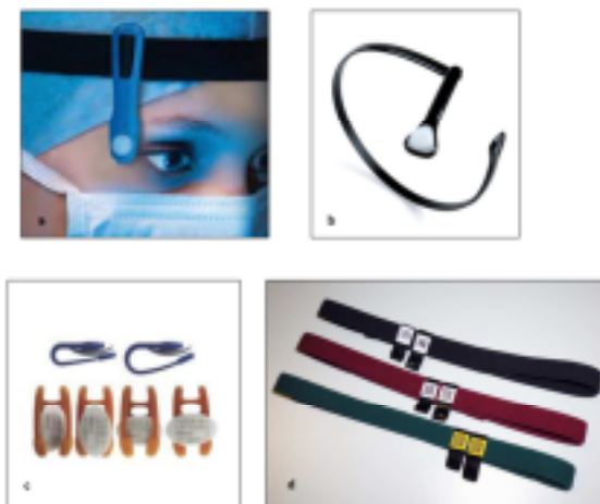
Fig 1 Dosimetri passivi. (a) TLD EYE-D™ ; (b) DOSIRIS™ ; (c) VISION™ (d) e OSL .
